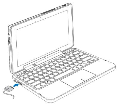
2 Conecte el adaptador de alimentación a una toma eléctrica y carque la tablet y el teclado hasta que la batería esté llena.
