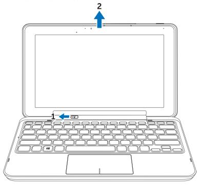
**NOTA:** El pestillo de liberación se moverá automáticamente hacia la posición *Bloqueado* una vez retirada la tablet del teclado.
